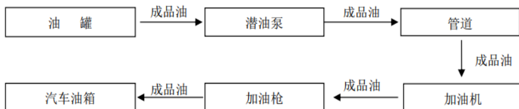
图 2.6.1-4 柴油加油工艺流程图
