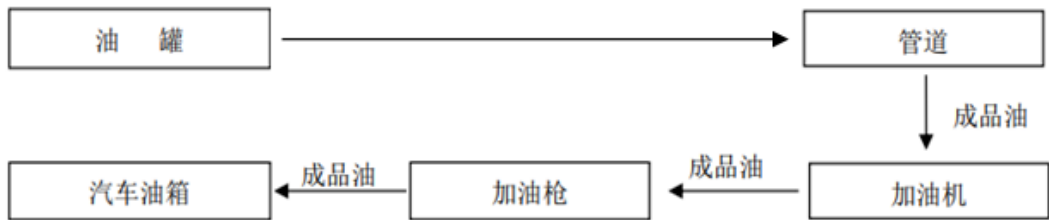
图 2.4.1-4 柴油加油工艺流程图
