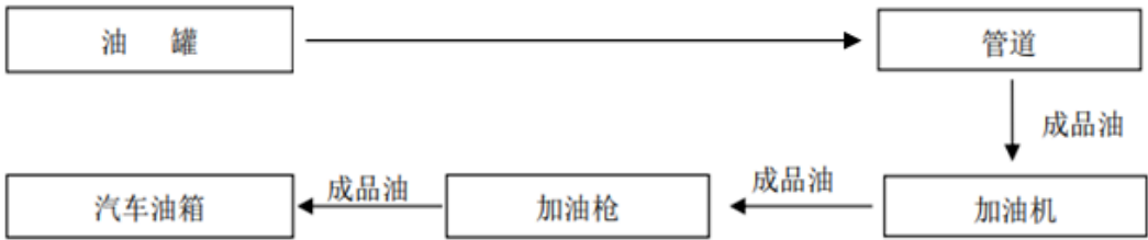
图 2.4.1-4 柴油加油工艺流程图
