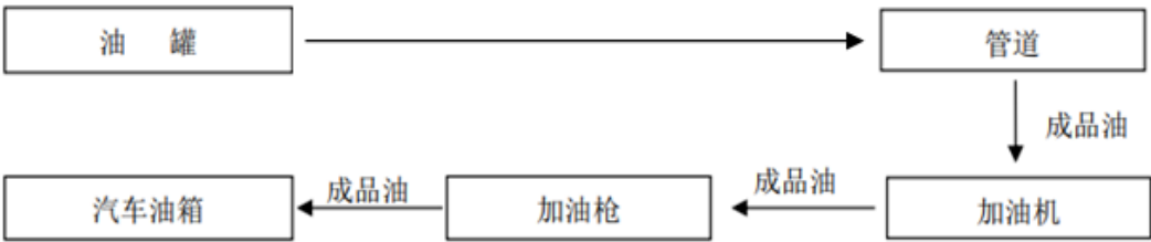
图 2.4.1-4 柴油加油工艺流程图
